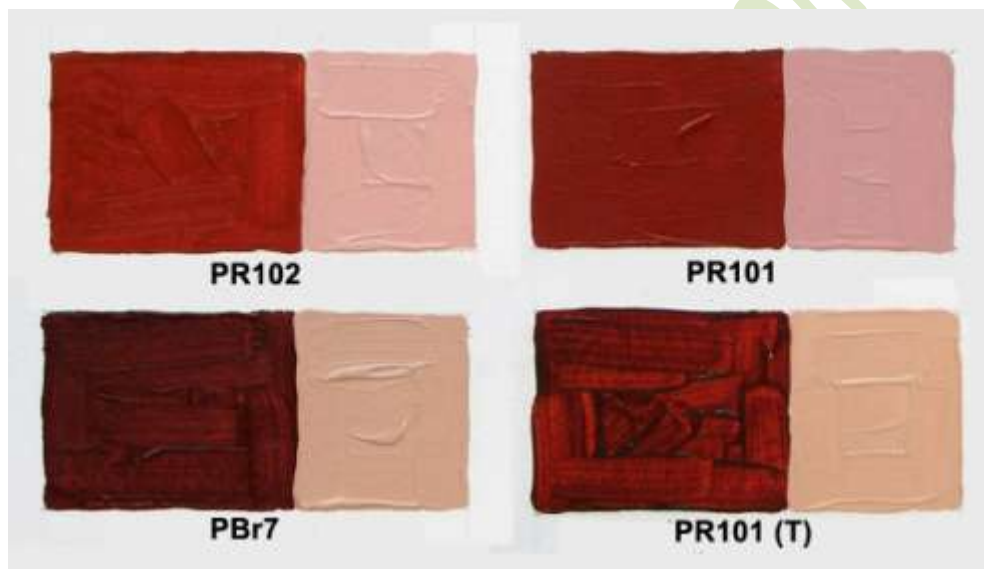
Figura 16: PR102 (vermelho óxido natural), PR101 (vermelho óxido sintético), PBr7 (sena queimada) e PR101 (T) (vermelho óxido transparente).
